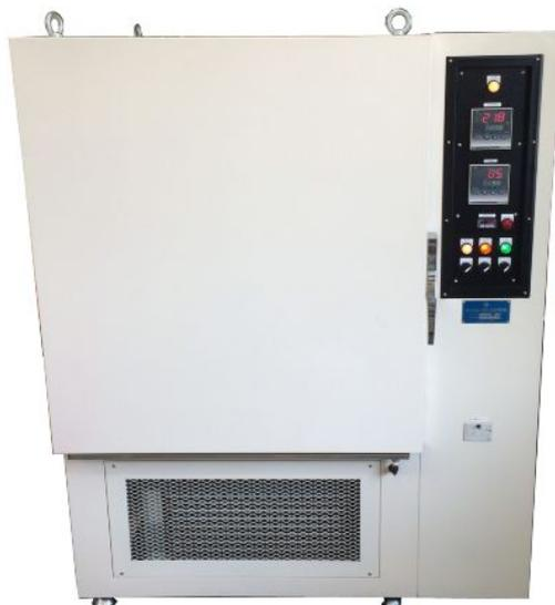
セメントの強さ試験等に必要な養生槽で多湿条件での長期連続運転が可能です。内装はステンレス製で耐久性に優れています。またPID制御で高い精度を保ち、温湿度をデジタルで表示致します。
