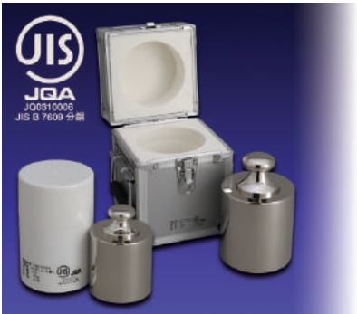
JIS マーク付基準分銅型円筒分銅 (非磁性ステンレス)
