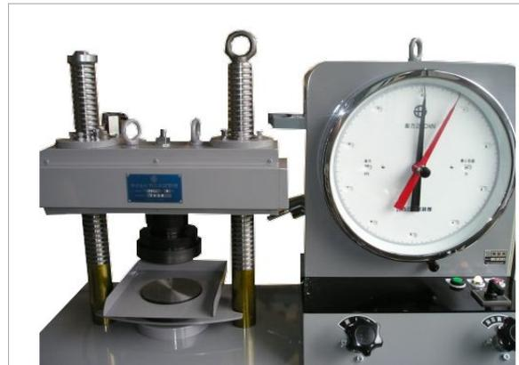
本機はアムスラータイプのモルタル圧縮試験機で最大容量200 kN（5レンジ又は4レンジ）の切替式となっております。目盛は最高荷重の1/500で低圧荷重より高荷重まで精度よく測定出来ます。又、クロスヘッドは固定式/電動昇降式の2タイプよりお選び頂けます。
