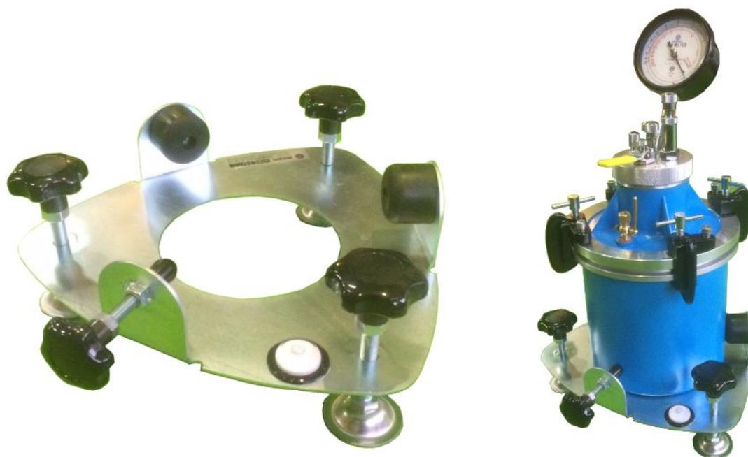
本商品はワシントン型エアメーター用水平器になります。今までの水平器では試験中に側面を木ハンマーで打撃した時に、エアメーターがずれてしまい、水平が保てなくなることがありましたが、本商品はエアメーターと水平器を、横方向からクランプボルトを締め付けることで、エアメーターと水平器を固定することができるので、打撃した時のズレが生じず水平を保つことができます。
