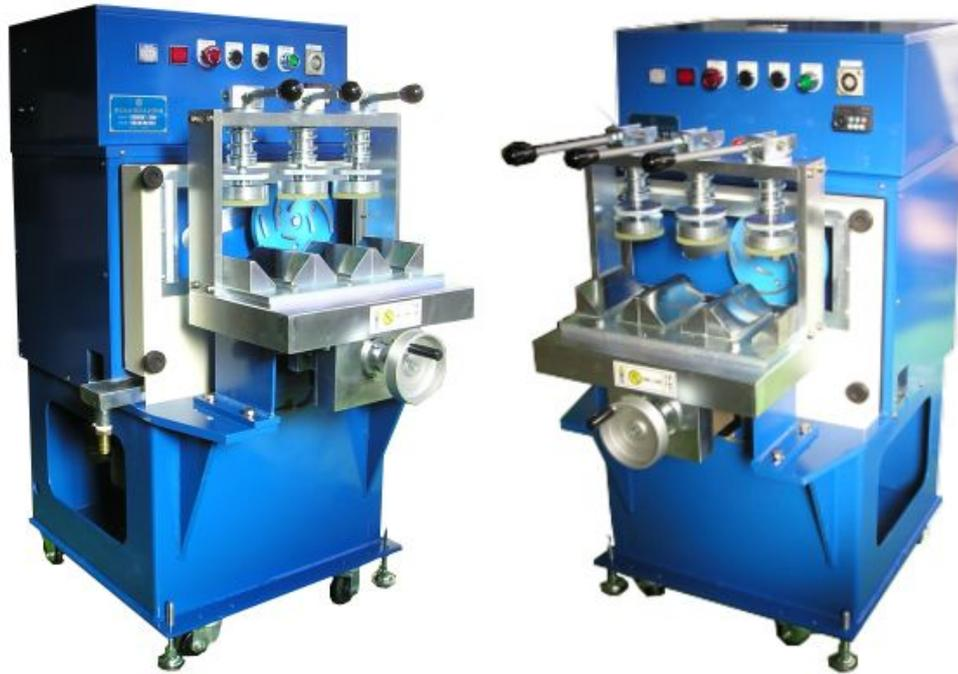
本機はコンクリート供試体の端面を3本まで同時に研磨する事が出来ます。
