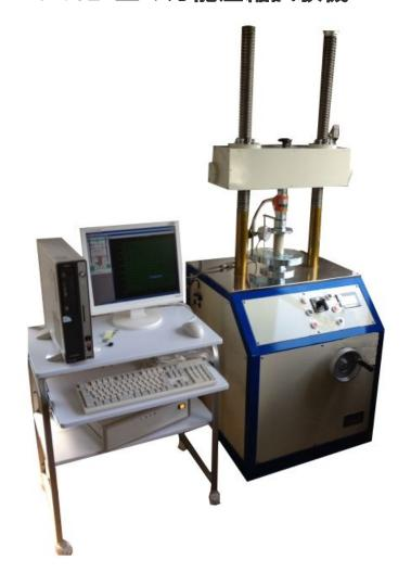
本機は電動スクリュージャッキを使用した、歪み制御型の圧縮試験機です。歪み速度が容易に変更でき クロスヘッドの上下移動も電動モーターにより行うことが出来ます。様々な土の歪み制御試験に活用され ます。又、自動計測システムを組み込むことにより試験開始からデータ取りまで自動で行うことが可能と なります。
